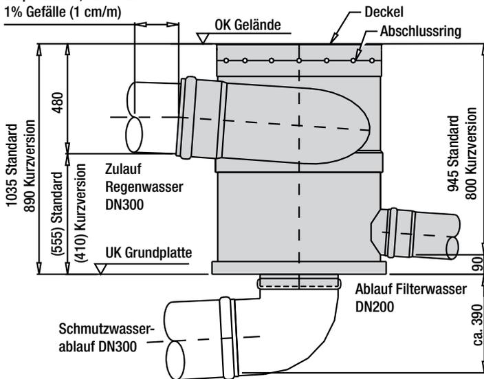
Schmutzwasserablauf zum Kanal oder zur Versickerung DN 300
