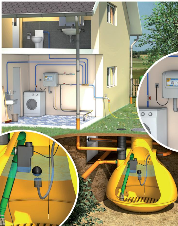
Das Regenwasserwerk Sigma ist idealerweise im Haustechnikraum untergebracht. Die einfachen und robusten Komponenten haben sehr geringen Wartungsbedarf.
