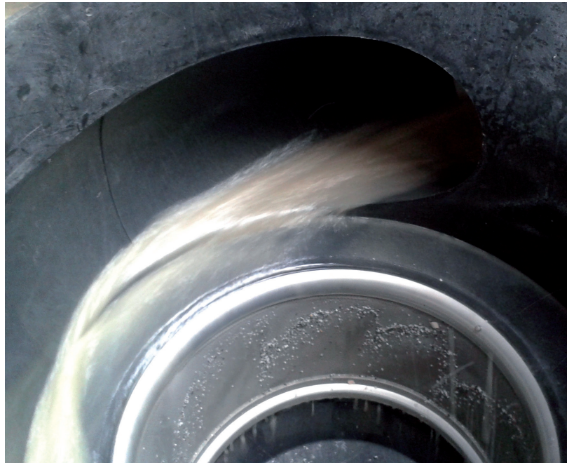
Reinigung von Abwasser bei der Betonherstellung in einem Pflastersteinwerk in Clermont-Ferrant, Frankreich
