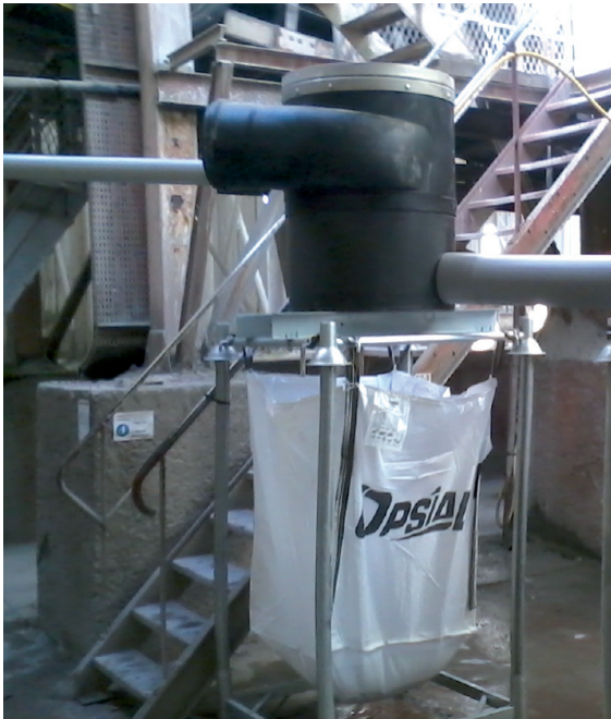
Reinigung von Abwasser bei der Betonherstellung in einem Pflastersteinwerk in Clermont-Ferrant, Frankreich
