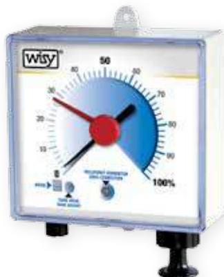
Zeigt den prozentualen Füllstand der Zisterne an. Pneumatisches Messgerät zur Fernmessung bis 50 m. Stufenlos einstellbar für Tanks mit maximalen Wasserstandshöhen von 1 bis 2,5 Meter. Schlagfestes Kunststoffgehäuse. Mit 20 m Messleitung und Befestigungsteilen.
