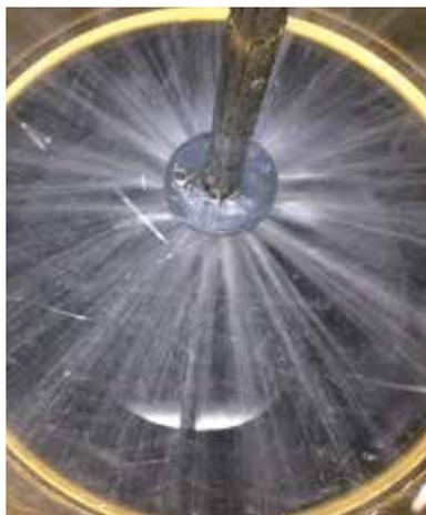
Mit der selbsttätigen Reinigungsdüse kann der Wirbel-Fein-Filter auch besonders anspruchsvolle Aufgaben im Wasserrecycling- oder in Separationsanlagen übernehmen. Eine Düse reinigt dabei den Filter mit vielen feinen Wasserstrahlen.
