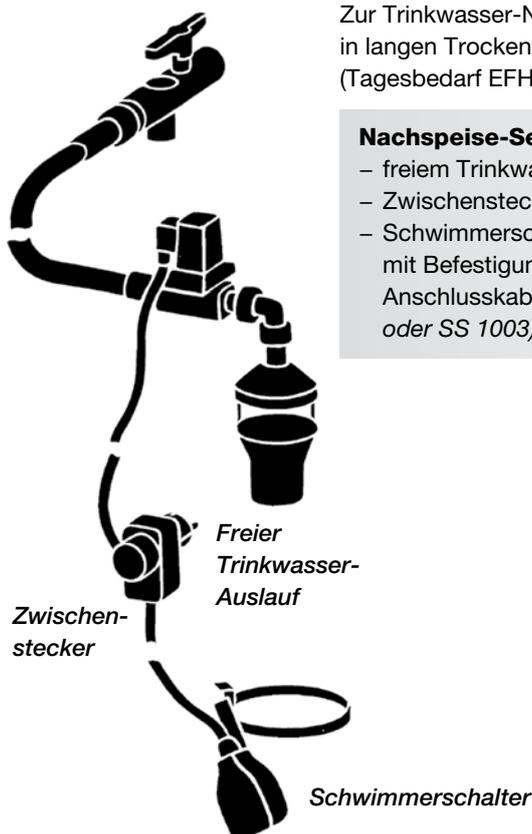
Zur Trinkwasser-Nachspeisung, speist den Regenspeicher in langen Trockenzeiten bedarfsgerecht mit Wasser nach (Tagesbedarf EFH). Entspricht DIN EN 1717.
