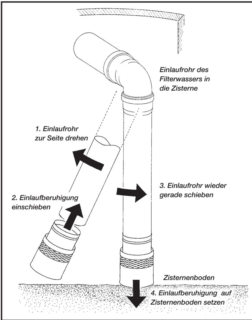
Bei der Einlaufberuhigung handelt es sich um eine echte Wasserbremse, die gleichzeitig durch die Konstruktionsform einen nach oben und breitflächig verteilten, ruhigen Wassereintritt in die Zisterne erreicht. Das Boden-Sediment bleibt dadurch völlig unberührt.
