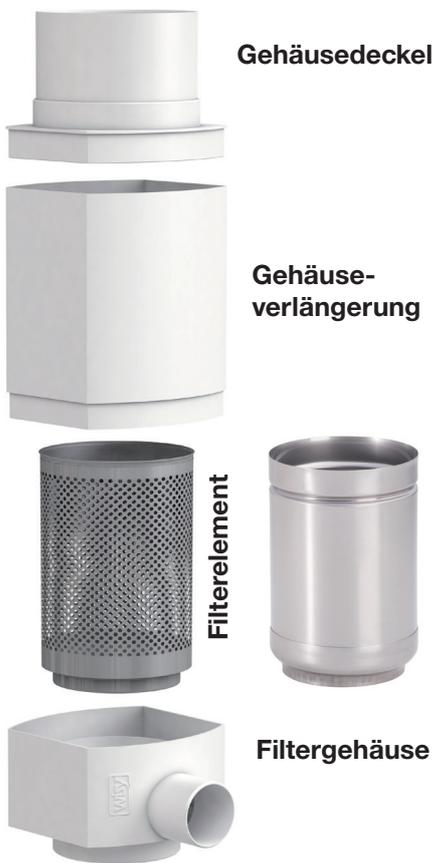
**Das Filterelement:** Das Filterelement ist das Herz des RegenSammler RS. Es ist komplett aus Edelstahl und besitzt eine Maschenweite von nur 0,28 mm. Schmutz wird automatisch fortgespült, so dass es zu einem hohen Grad selbstreinigend ist.
